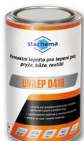
**Popis:** Unilep D418 sa používa v obuvníctve (lepenie PVC, kože, koženky, gumy, TPU). Ďalej na lepenie čalúnenia, autočalúnenia, lepenie a opravy gumotextílií a výrobkov z mäkčeného PVC). Lepí tiež polyestery, plexisklo, polyuretánové peny a pod. Spoj odoláva teplotám od -30 °C do +80 °C a je odolný voči zmäkčovačom. Poznámka: savé materiály môžu potrebovať 2–3 nánosy lepidla. DZ: 3–5 min, OD: 5–8 min
