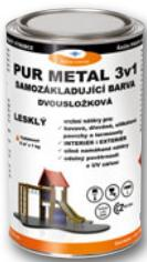
**Popis:** Dvojzložkový polyuretánový vrchný email lesklý určený pre samozákladajúce nátery tj. základný antikorózny a vrchný náter v jednom kroku, kovových, drevených, silikátových povrchov a termosetov. Na vonkajšie i vnútorné použitie a silno namáhané nátery. Vykazuje výborné mechanické vlastnosti, odolnosť voči UV žiareniu a poveternostným vplyvom všeobecne. 3v1 = základ, medzivrstva a vrchný náter v jednom kroku
