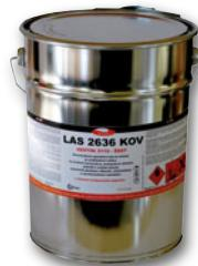
**Popis:** Dvojzložková epoxidová plniaca náterová hmota s obsahom antikorózneho pigmentu určená pre podkladové nátery na oceľové konštrukcie, priemyselné zariadenia, potrubia a ostatné plochy vystavené pôsobeniu vlhkosti, chemickému a mechanickému namáhaniu. Variant HB (highbuild) sa používa pre dosiahnutie väčších suchých hrúbok 80–120 µm v jednom aplikačnom kroku.
